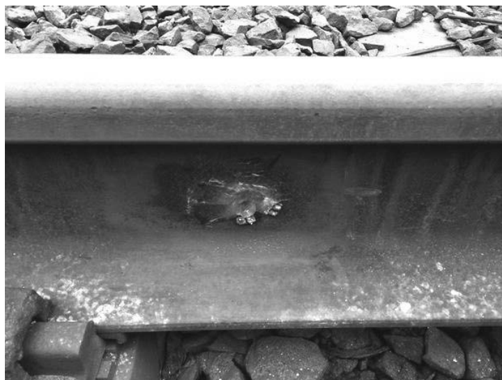
Рис. 4. Место закрепления тензометрического датчика
