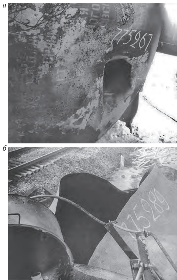
Рис. 1. Результаты аварийного режима: а — пробой днища котла автосцепкой вагона; б — последствия пробоя днища
