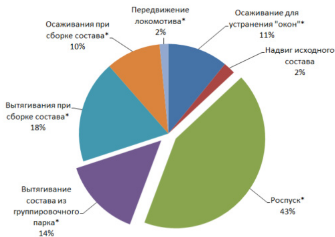
Рисунок 3.2 – Структура ТГИ' при многогруппной сортировке, степенной способ
