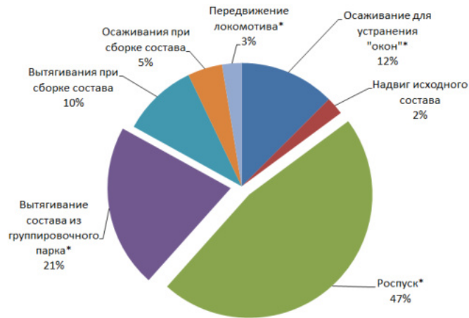
Рисунок 3.1 – Структура ТГИ' при многогруппной сортировке, комбинаторный способ
