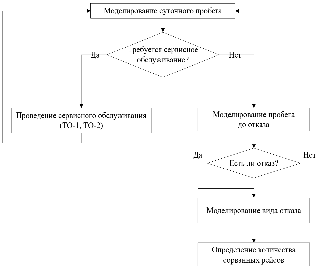
Рисунок 2.9 – Алгоритм прогнозирования количества отказов и сорванных рейсов [135, 146]
