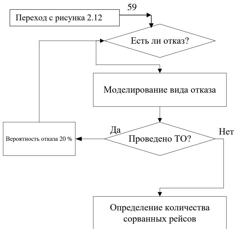
Рисунок 2.13 – Дополнение к алгоритму моделирования агента подвижного состава автомобильного пассажирского транспорта
