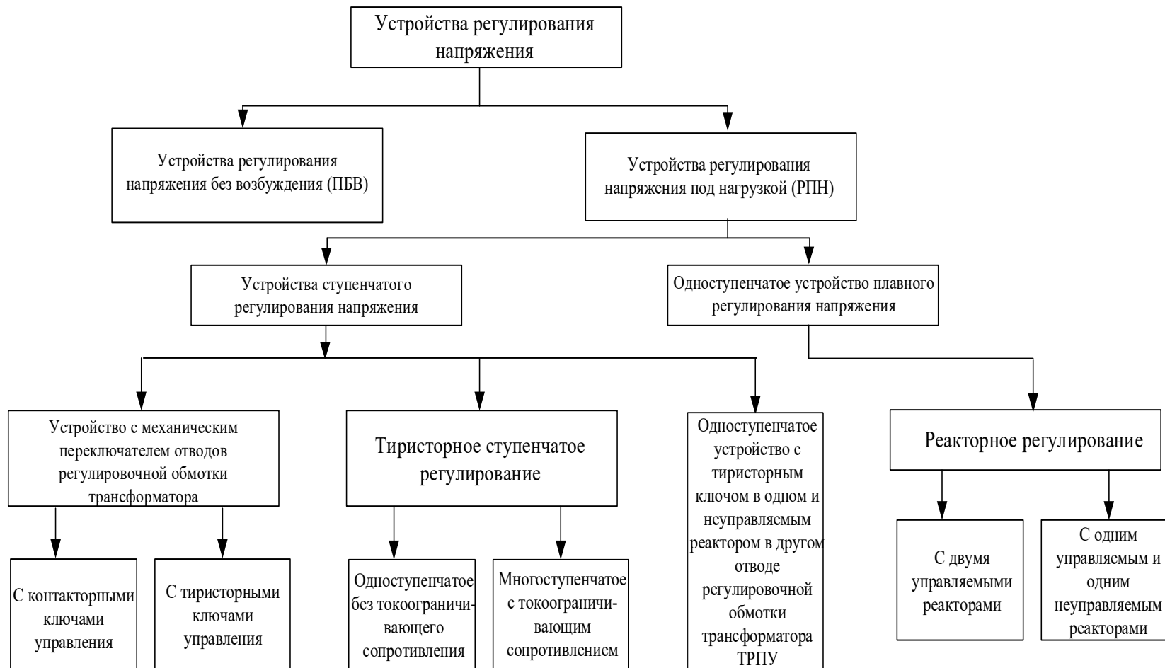
Рисунок 1.2 – Систематизация устройств регулирования напряжения трансформаторов
